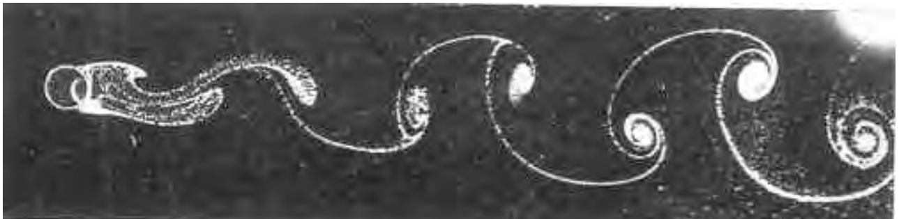
Vortici di Von Karman e linee di fumo nella scia di un cilindro rispettivamente per Re=32, 55, 65, 161 (da Homann, 1936)
