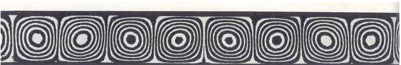
Esempio di instabilità dovute a convezione naturale all'interno di una scatola rettangolare in cui l'uniforme calore della parete inferiore produce dei vortici paralleli al lato più corto della scatola (classica convezione di Rayleigh-Bénard).
