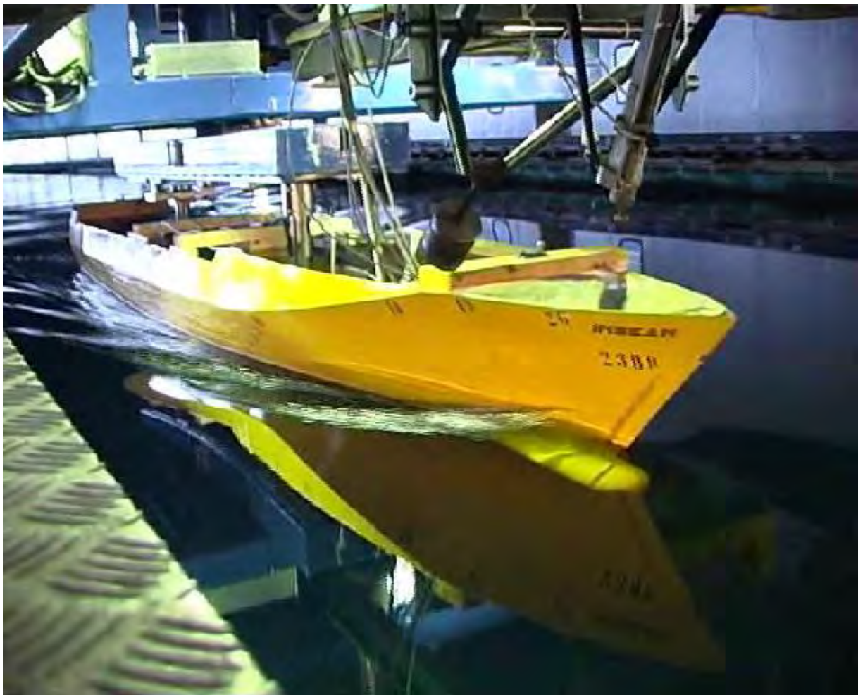
Modello in bacino di prova (INSEAN, Vasca Navale) e nave reale in mare calmo (scafo con bulbo).
