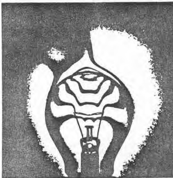
Campo di densità all'interno e all'esterno del bulbo di una lampadina calda ottenuto mediante interferometro Holografico.
